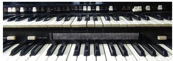
写真6 上下鍵盤の間にアルペジエーターがあり、この帯状に並んだローラーを指で触り左右に動かすと下鍵盤で押した和音にあわせたアルペジオが鳴る。アルペジエーターの左右にはタブヴォイスのキャンセルボタンとフルオルガン（Sforzand）ボタンが計3つある。
