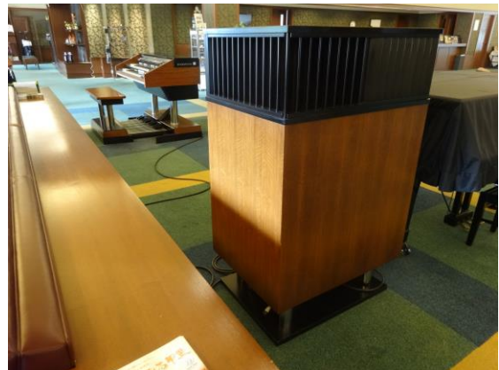
写真 8：X-66 専用トーンキャビネット 12-77。日本では納入時にレスリー接続回路やコントローラーを追加し、レスリースピーカー 122RV を付加する場合もあった。
