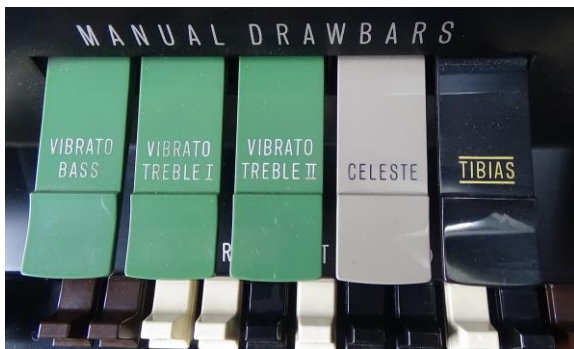
写真 7：上段、X-66 本体内部のアニメーター。3つの異なる径を持つプーリーがモーターによって回転し揺らぎを生じる。下段、パネルの 5 種タブレットを組み合わせることでドローバーの音色に揺らぎを与える。
