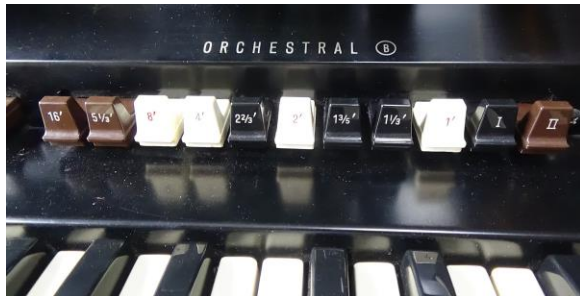
写真4 上段：X-66 上鍵盤（オーケストラ）のドローバー11本が一組となっている。下鍵盤（アカンパニメント）は10本が一組となっている。上下鍵盤にそれぞれ二組装備されている。
