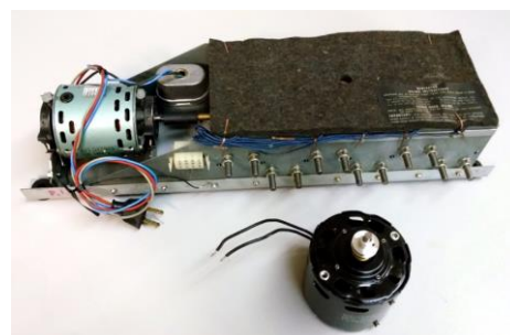
写真 12：米国より入手した X-66 の 60Hz 仕様トーンホイールジェネレーター式とアニメーションモーター（60Hz 仕様）
